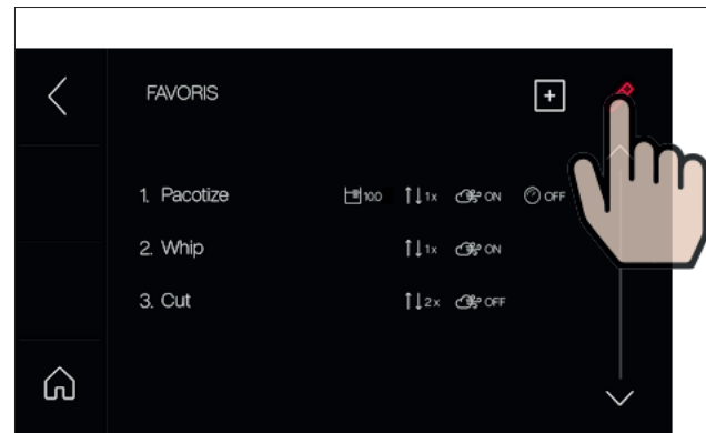
En sélectionnant l'icône du crayon, l'ordre peut être modifié ou les favoris peuvent être supprimés.
