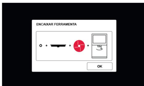
**i** **Nota:** Se a proteção contra respingos não estiver montada corretamente ou for utilizada ferramenta incorreta para o procedimento de bater, aparece uma mensagem de erro.
