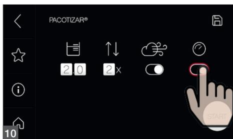
Se desejar um processamento mais rápido, ligue-o com o botão modo Jet® (tempo de processamento 90 segundos). O número de repetições é automaticamente ajustado em 2 e pode ser alterado posteriormente.
