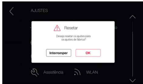
**Resetar:** Se o aparelho for resutado para o estado de fábrica, todos os dados e ajustes se perdem (p.ex. favoritos). Valores de contador ed Event Log são mantidos.
