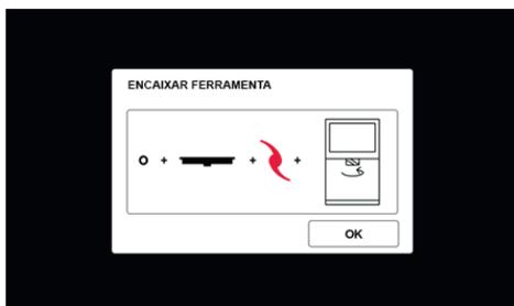
**i Nota:** Se a proteção contra respingos não estiver montada corretamente ou for utilizada ferramenta incorreta para o procedimento de corte, aparece uma mensagem de erro.
