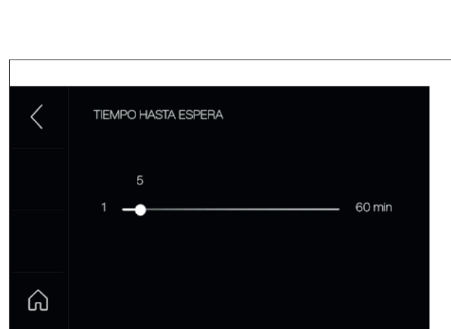
En espera: la máquina pasa al modo de reposo después de 1 a 60 minutos.
