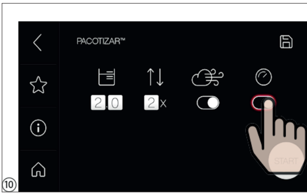
10 Si desea un procesamiento más rápido, conéctelo con el botón del modo Jet® (tiempo de procesamiento 90 segundos). Al hacerlo, el número de repeticiones se ajusta automáticamente a 2 y puede modificarse posteriormente.
