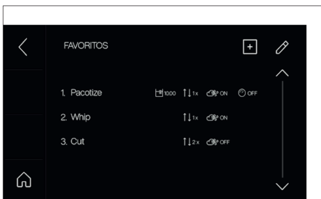
Favoritos: las recetas más importantes se guardan con los ajustes de procesamiento (tamaño de porciones, número de repeticiones, presión normal/sobrepresión, procesamiento más rápido).
