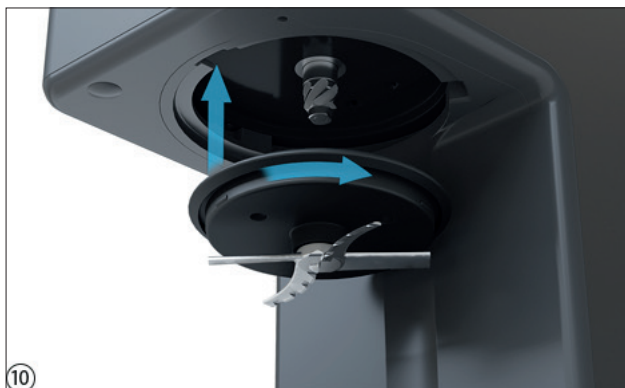
10 Para el ciclo de enjuague: asegúrese de que el protector contra salpicaduras con la cuchilla para pacotizar™ esté fijado al acoplamiento de la herramienta.
