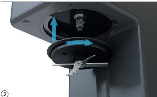
③ Fissare il gruppo composto da protezione antispruzzo, pre-raschiatore e aletta per pacossare all'attacco utensile presente sull'albero di pacossatura. L'aletta per pacossare è fissata correttamente quando aderisce bene all'apposito attacco.
