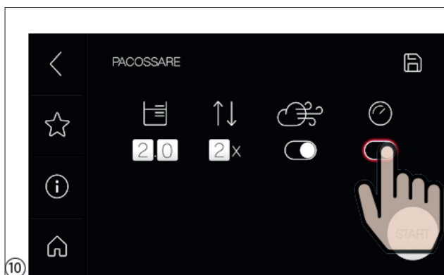
10 Se si desidera una lavorazione più rapida, attivare la relativa funzione mediante il pulsante Modalità Jet® (tempo di lavorazione: 90 secondi). In questo caso, il numero di ripetizioni viene impostato automaticamente su 2 e può essere modificato in seguito.
