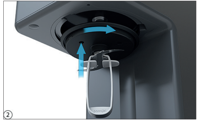
② 请使用刀钳将 组合刀具刀片与防溅护盖一起安装在设备上。当组合刀片牢固附着在刀具联轴器上时，才算正确固定好。将 Pacotizing® (鲜爽冰磨) 缸杯和防护杯一并装上。
